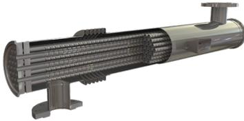
La Serie HRS SI es una serie de intercambiadores de calor de carcasa y tubos con un grado de seguridad añadido pues están equipados con una doble peana que aporta un detector de fugas para evitar la contaminación entre el lado producto y el lado servicio.
