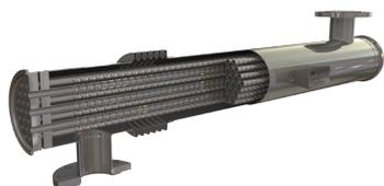
La Serie HRS SP es una serie de intercambiadores de calor de carcasa y tubos con un grado de seguridad añadido pues están equipados con una doble peana que aporta un detector de fugas para evitar la contaminación entre el lado producto y el lado servicio.
