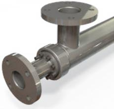
La Serie HRS DTIR es un intercambiador de calor de doble tubo en acero inoxidable, diseñado para aplicaciones industriales y medioambientales. El producto fluye a través de los tubos interiores y el fluido de servicio fluye a través de la camisa. Como resultado de su geometría, la Serie DTIR presenta una sección transversal continua de paso libre que permite procesar partículas grandes, lo que reduce en gran medida el riesgo de bloqueos del producto.
